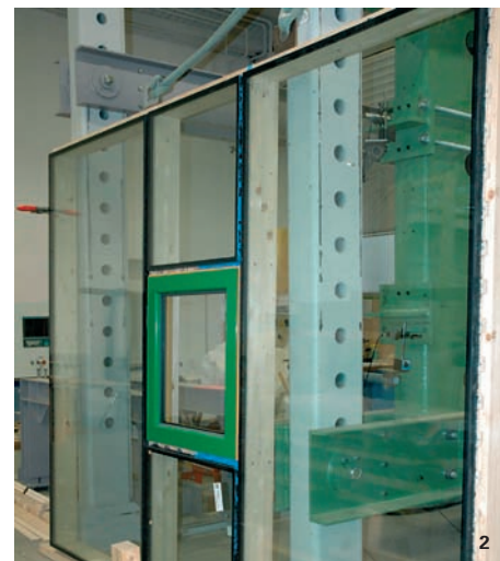
2 Holz-Glas-Verbundelement am Bauteilprüfstand
