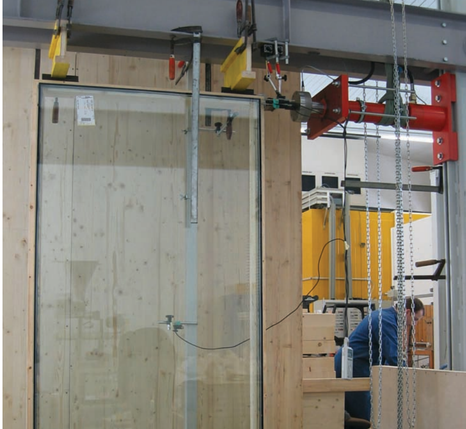
Der neue Bauteil-Prüfstand der Holzforschung Austria, mit dem die Leistungsfähigkeit von neuartigen Bauelementen getestet werden kann
