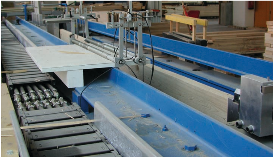
Im Rahmen des Kompetenzzentrums Holztechnologie wurde eine moderne, leistungsfähige Zugprüfmaschine angeschafft
