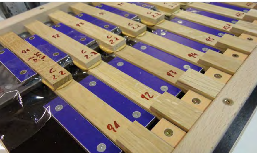
Für die Festigkeitsuntersuchungen werden mittels Schablone Zugscherproben mit definierter Klebefugendicke hergestellt.
