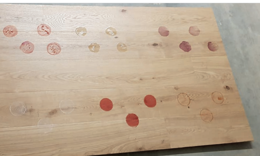
Auf die Probeflächen der Dielen bzw. im Fugenbereich wurden pulverförmige, pastöse, fette und färbende Substanzen aufgebracht und 96 Stunden belassen.
