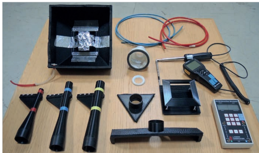
Auswahl an Instrumenten der Messsondenausrüstung: drei Messstrecken, unterschiedliche Messadapter sowie Hitzdrahtanemometer und Differenzdruckmessgerät
