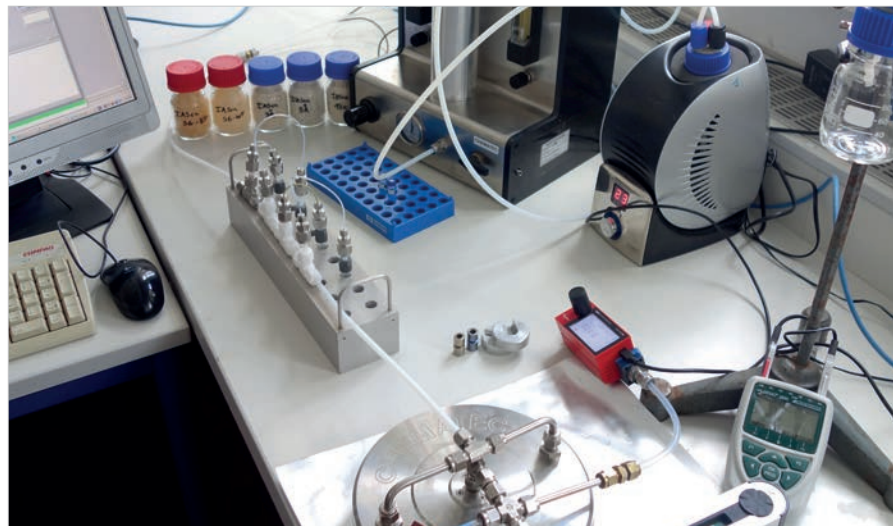
Von HFA-MitarbeiterInnen im Projekt entwickelter Schnelltestaufbau zur konstanten Zugabe der Modellschubstanzen.
