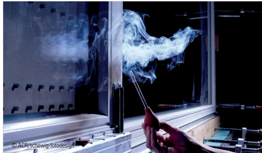
Die Leckageortung wird im Zuge von Produktentwicklung oder zur Schadensermittlung eingesetzt.
