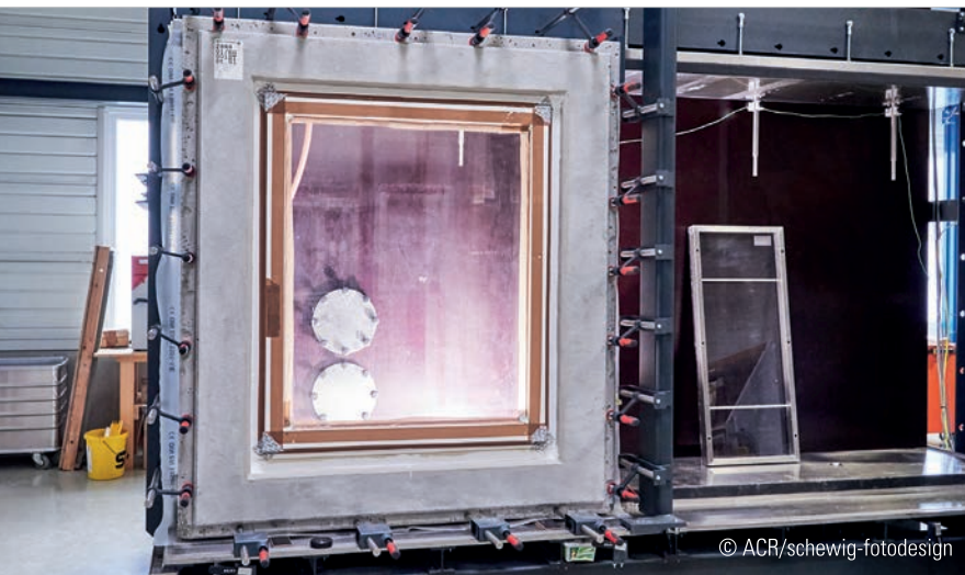
Leckageprüfung am neuen, hochmodernen Prüfstand, der im Zuge des Projektes angeschafft wurde.
