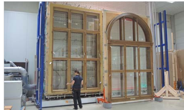
Sanierte Kastenfenster eines bedeutenden historischen Gebäudes aus Prag am HFA-Prüfstand.
