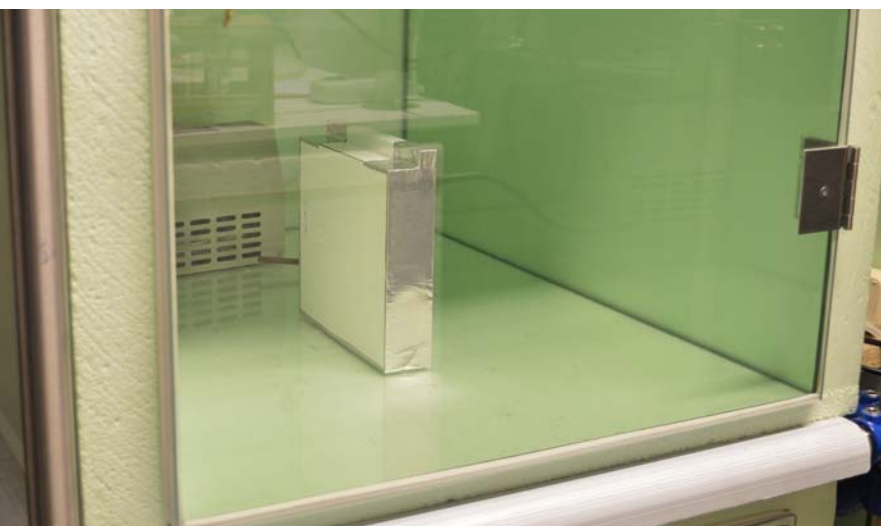
Prüfstück einer Tür mit abgeklebten Schnittkanten bei der Emissionsprüfung an der Holzforschung Austria
