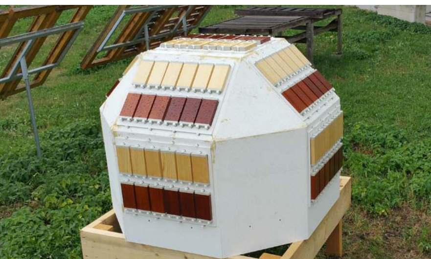
Für das Projekt Servowood wurde eigens ein mehrseitiger Bewitterungsstand (MFER, multi-faceted exposure rig) konzipiert, aufgrund seines Aussehens in der Forschergemeinde gerne kurz als „Sputnik“ bezeichnet.
