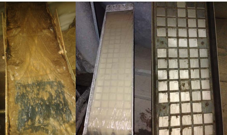
Platten in der Bypass-Testrinne während der Exponierung mit Ablagerungen (links) und Plättchen während des Sukzessionsexperimentes (mittig), exponierte Plättchen (rechts)
