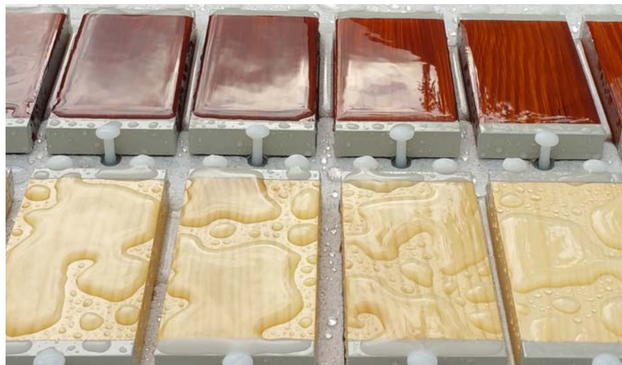
Beregnete Oberflächen verschiedener Holzarten und Beschichtungen im Langzeit-Freilandbewitterungsversuch im Projekt Servowood
