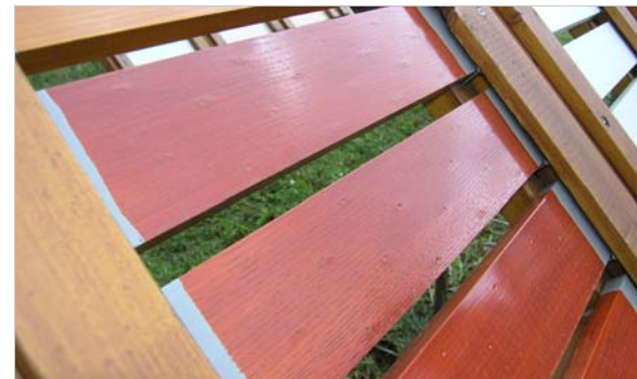
Die Entwicklung von Folgeschäden wird in Freilandversuchen mit Proben mit Hagelschlagsimulation untersucht
