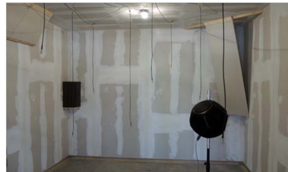
Messsituation zur Bestimmung der Nachhallzeit im Senderaum des Normprüfstandes
