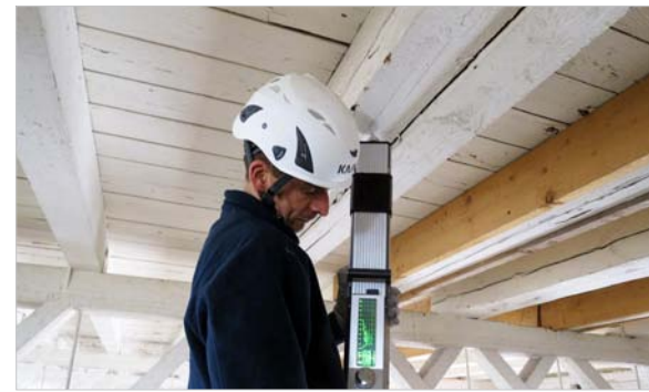
Bohrwiderstandsmessung mittels Resi PD300 im Praxiseinsatz
