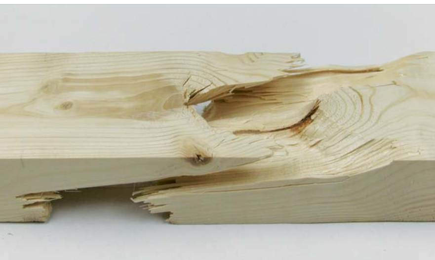
Gebrochener Prüfkörper aus dem Teilprojekt „Grain deviation“, das sich mit der Erkennung von lokaler Faserabweichung beschäftigte
