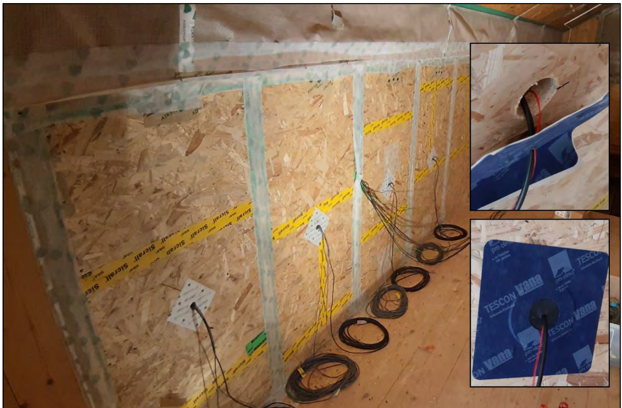
Abbildung 16: Frontaler Einbau der Kombifühler (Messposition „a“).
