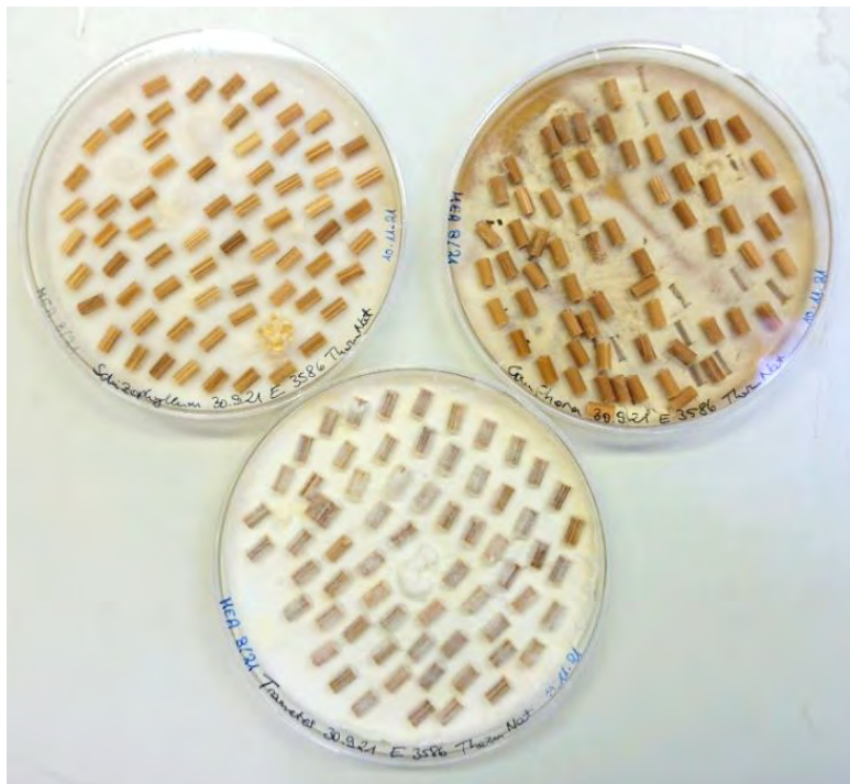
Abbildung 26: oben links - Vorbereitung von infizierten Holzdübeln (oben links: Schizophyllum commune , oben rechts: Coniophora puteana , unten: Trametes versicolor ) und rechts mit Dübeln „beimpften“ Probekörper.
