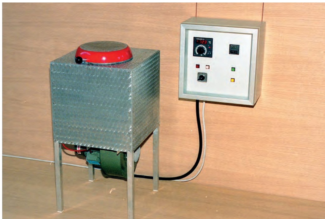
In den 1980er Jahren wurde am Institut ein Heißluftschnelltrocknungsgerät für Späne entwickelt
