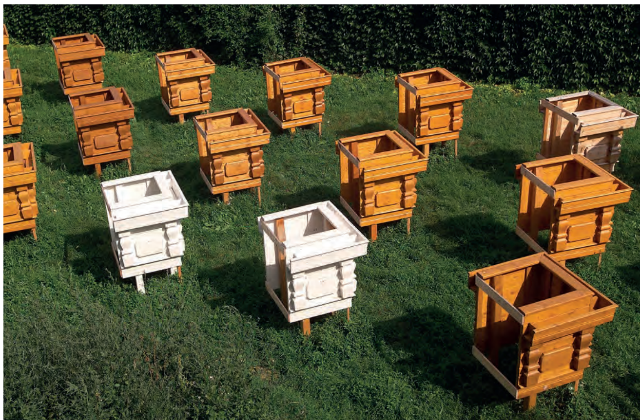
Bewitterungsversuche von Holzbalkonen am Freigelände im Wiener Arsenal
